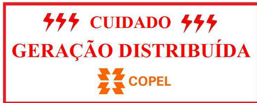
Figura 5.1 - Placa de Advertência (210 x 100mm)
