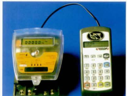
Equipamentos básicos do sistema de pré-venda de energia: à esquerda, são mostrados os equipamentos do posto de venda (máquina registradora e leitora de cartão), além do smartcard ; à direita, aparecem os equipamentos instalados na residência do usuário (medidor inteligente e leitora de cartão).
