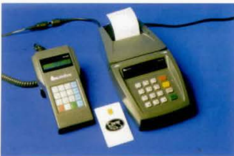
Equipamentos básicos do sistema de pré-venda de energia: à esquerda, são mostrados os equipamentos do posto de venda (máquina registradora e leitora de cartão), além do smartcard ; à direita, aparecem os equipamentos instalados na residência do usuário (medidor inteligente e leitora de cartão).
