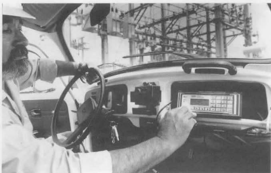
De dentro do carro, o electricista opera as chaves religadoras da subestação
