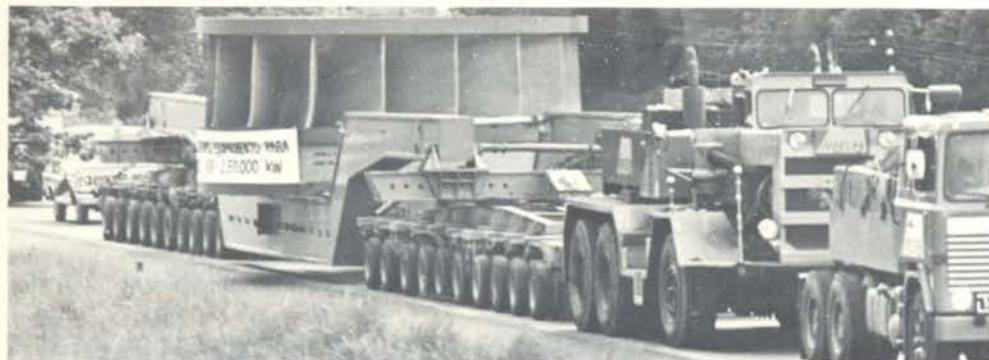
Proveniente de Santos, já se encontra em Foz do Areia, o Cubo de Rotor para a primeira Turbina da Usina. Fabricado pela Hitachi do
