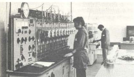
As mesas de aferição de medidores, montadas no DPMD, foram as primeiras a serem instaladas na América do Sul.
