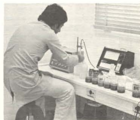
Auxiliar Técnico Romeu Caetano Granato, procedendo a determinação de pH em amostras de solo (análise requisitada pelo CROG).
